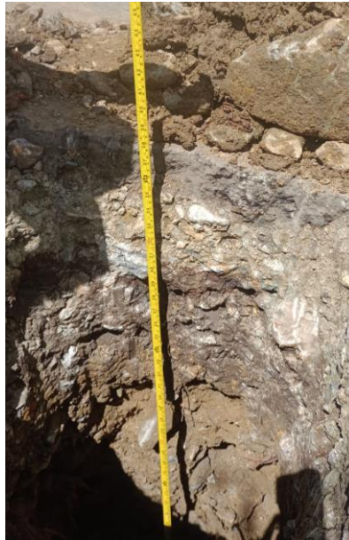
Fotografía 12. Estratos observados en la calicata No. 2 Fuente: Tomado en terreno.
