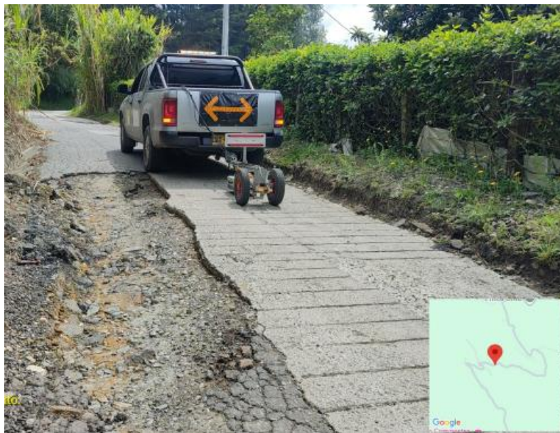
Fotografía 4. Georadar marca MALA. Fuente: Tomado en terreno
