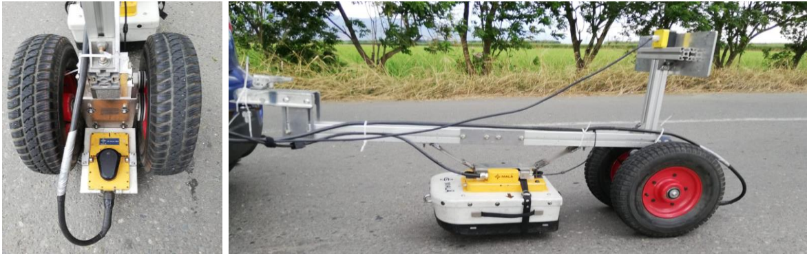
Fotografía 4. Georadar marca MALA. Fuente: Tomado en terreno
