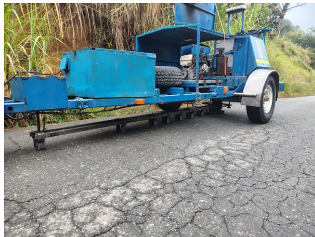
Fotografía 6. Evaluación Estructural con Deflectómetro de Impacto Fuente: Tomado en terreno
