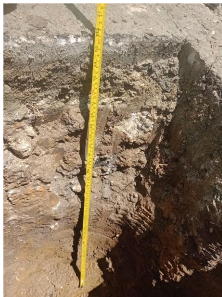
Fotografía 9. Estratos observados en la calicata No. 1 Fuente: Tomado en terreno.
