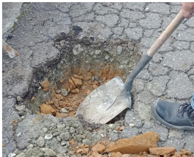
Fotografía 13. Excavación de la calicata No. 3 Fuente: Tomado en terreno.
